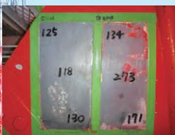
塗膜はく離作業後に残存した塗膜の種類、残存塗膜厚、再度の塗付作業の必要有無を確認、記録します。
