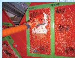
手工具(刃付スクレーパー等)で、塗膜はく離作業をおこないます。異なる塗付量で比較試験をおこなった場合、塗膜はく離結果の他、塗付量毎の作業状況を記録します。
