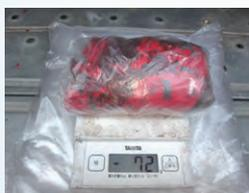
はく離した塗膜の重量を測定し、発生する塗膜廃棄物の重量を把握します。
