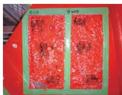
塗付後、18時間以上経過後、塗膜が軟化膨潤した状態であり、はく離作業が可能であることを確認します。
